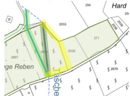
Bei den Varianten 1 und 2 wird die bestehende Leitung durch eine neue Leitung mit grösserem Durchmesser ersetzt. Die Linienführung bei Variante 1 (blau) folgt dem heutigen Trassee und verläuft etwas schräg zum Hang, beginnt nördlich der Parz. 2668 bei der Jungrebenstrasse und schliesst bei der Rüden-Jungreben-Hardstrasse an die bestehende Leitung an.
